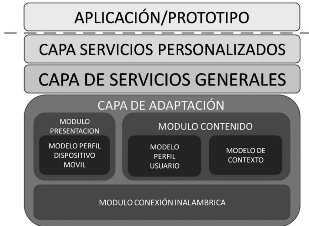
Fig. 2. Arquitectura de la plataforma PlaSerEs.
